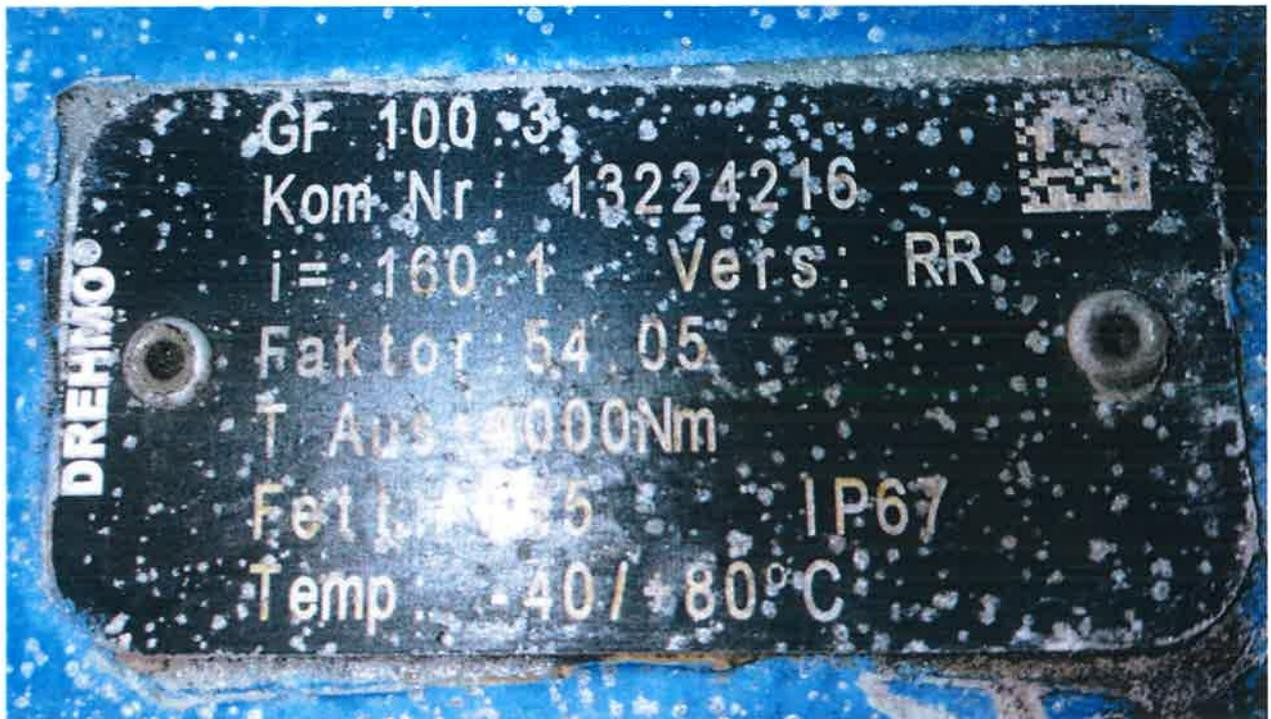
Предавателния механизъм служи за задвижване на клапан сух газ на мелещия вентилатор
