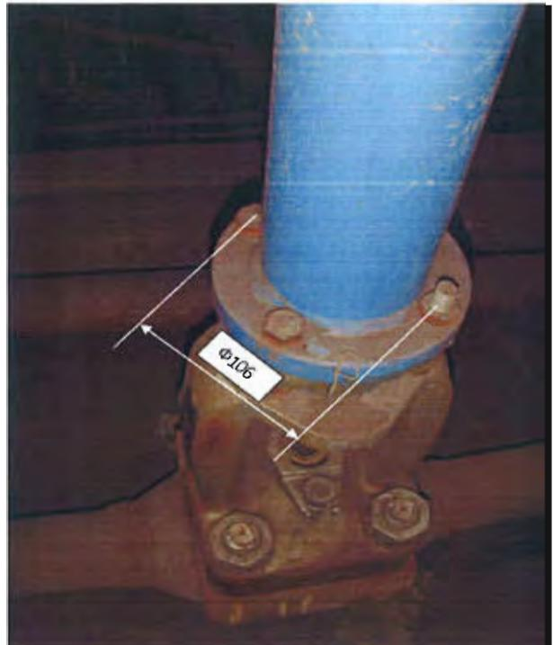
Присъединяването на вентила към приводния механизъм се осъществява посредством 4 болта M10 на делителен диаметър  $\Phi 106$  мм.
